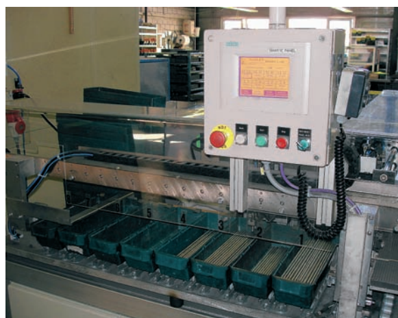
Die Bedieneinheit der Messanlage mit grossem Display
